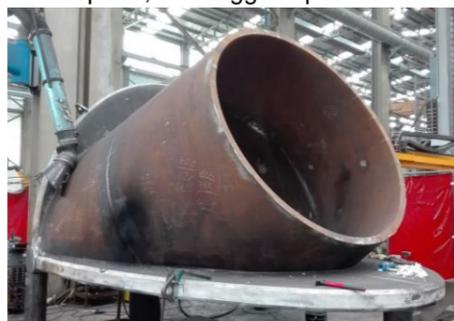
La biforcazione è stata costruita con tubazioni troncoconiche realizzate dalla calandratura di virole aventi spessore di 65 mm, realizzate con lamiere in acciaio tipo S500 QL secondo EN 10025-6 ed è dotata di un rinforzo assiale e uno anulare di spessore 150 mm; l'angolo di deviazione è di 55°.
